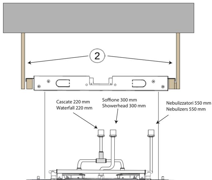
IT - Prima di agganciare il corpo soffione al telaio di supporto assicurare il soffione al telaio per mezzo di cavi di sicurezza Fig.2(1); se il telaio fosse agganciato al controsoffitto (Fig.3) per maggiore sicurezza e stabilità assicurare anche il telaio a dei ganci di sicurezza (2) (non forniti) al soffitto in muratura.
