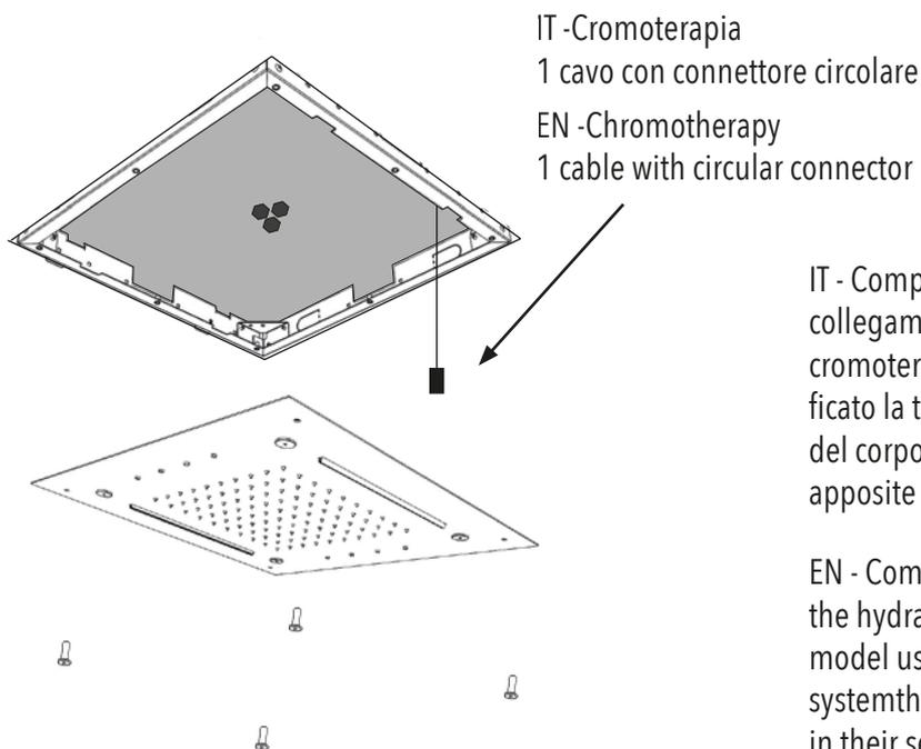
IT - Completare l'installazione del soffione eseguendo i collegamenti idraulici ed elettrici (nel caso dei modelli con cromoterapia seguire le istruzioni allegate); dopo aver verificato la tenuta idraulica del sistema procedere al fissaggio del corpo soffione sul telaio di supporto avvitando le viti nelle apposite sedi.
