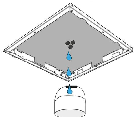
IT - Assicurarsi di svuotare e pulire l'impianto idrico prima di collegare il corpo soffione.
