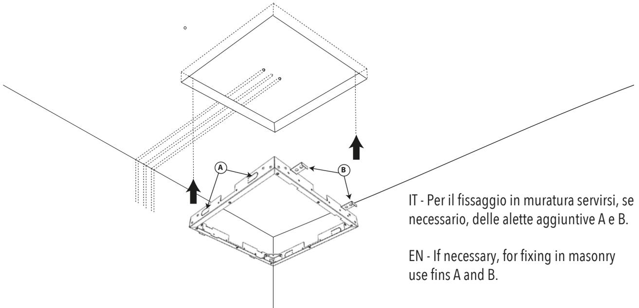
IT - Per il fissaggio in muratura servirsi, se necessario, delle alette aggiuntive A e B.
